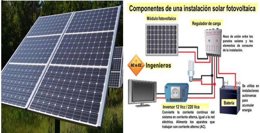
Figura 2-15 Energía solar fotovoltaica directa.
