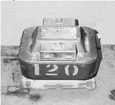
Figura 4-14 PT de baja tensión. Cortesía de Alliant Energy.
